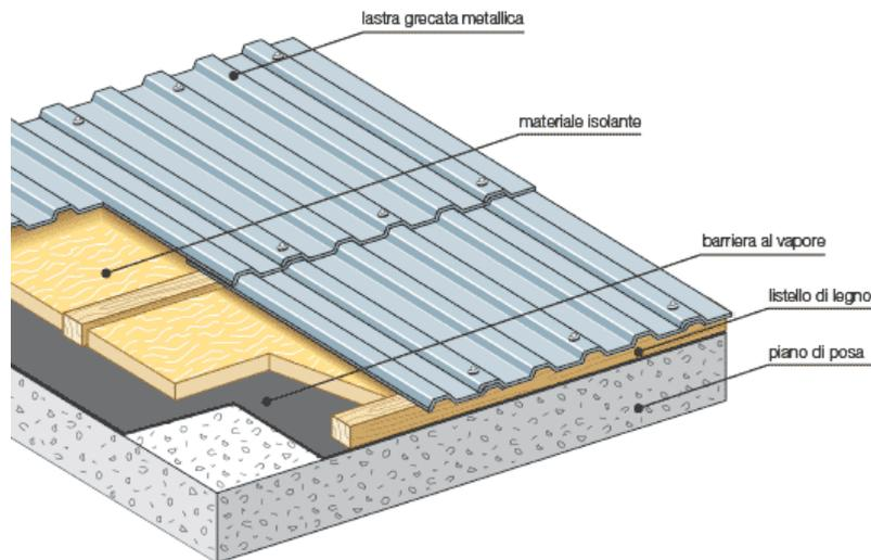
L'isolamento della copertura consente di ridurre le dispersioni termiche e, di conseguenza, di generare una riduzione del consumo energetico legato al riscaldamento dell'edificio.
